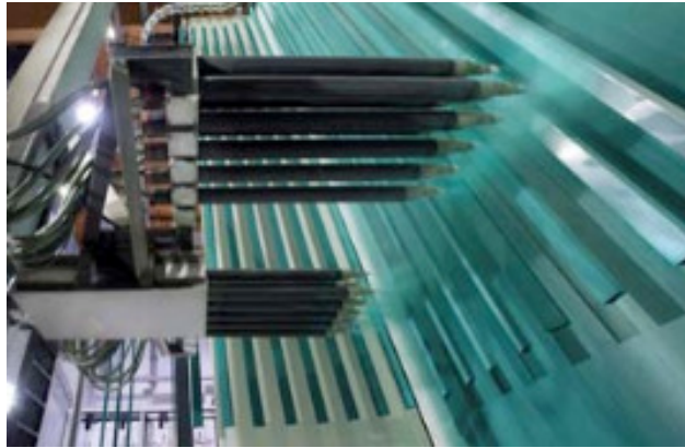
Abbildung 5: Automatisierte Pulverbeschichtung (Foto: © Schlotterer)
